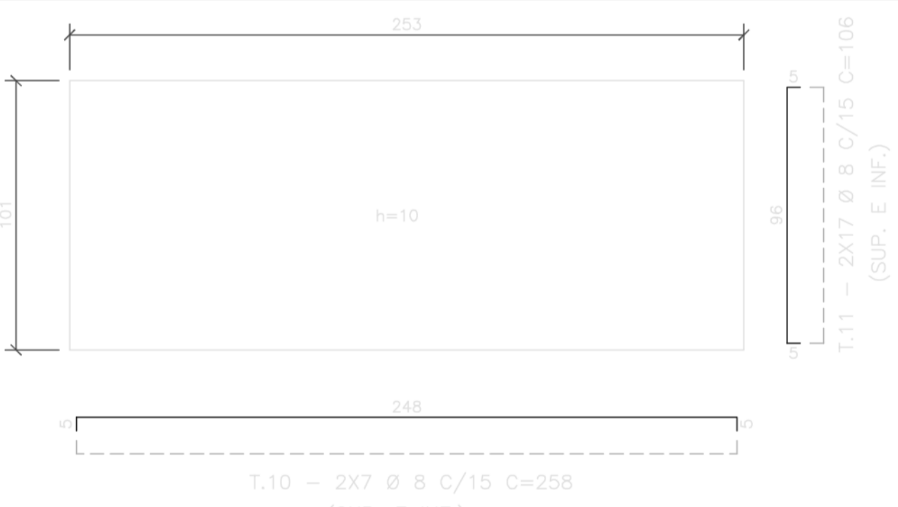
LAJE DA TAMPA DA B. L. ESC. 1:20
