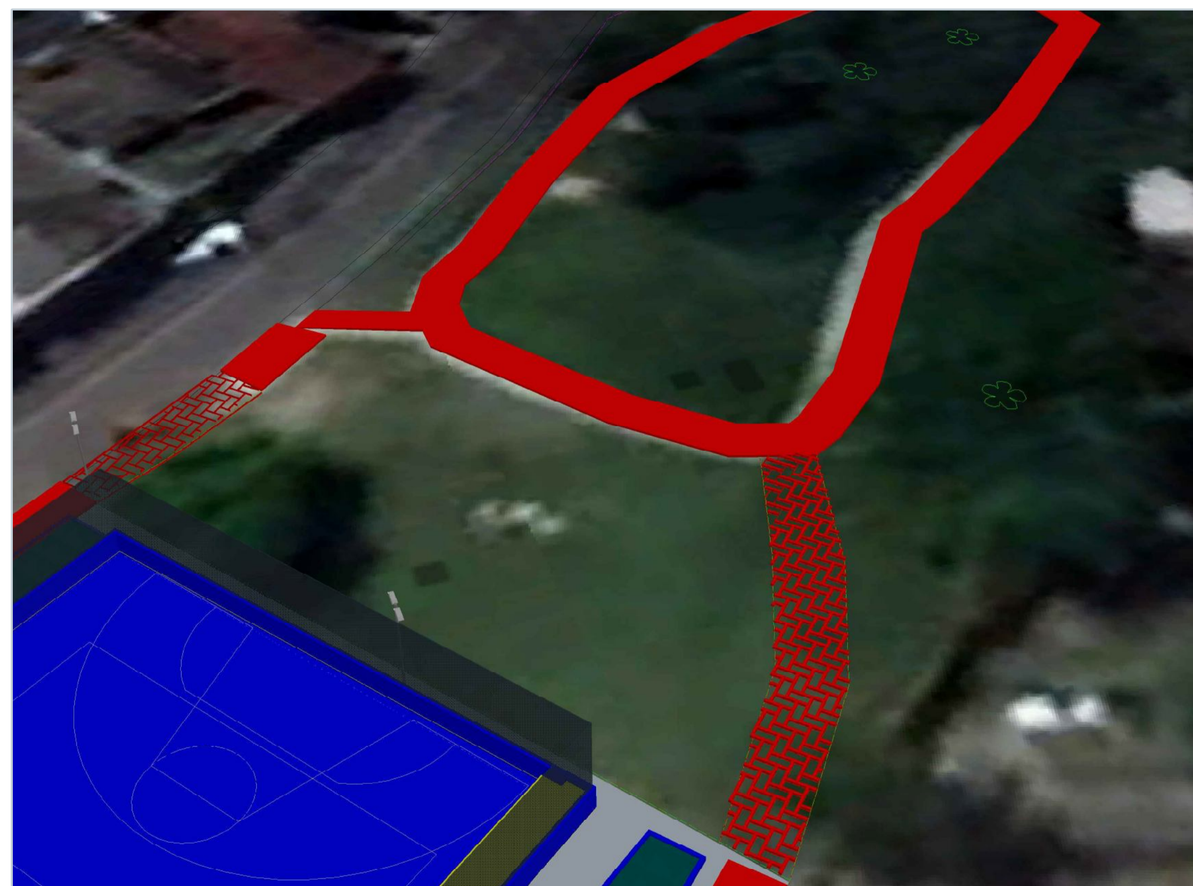
INTERLIGAÇÃO ENTRE A PRAÇA E PISTA DE CAMINHADA POR MEIO DE CAMINHO DE BLOCOS INTERTRAVADOS
