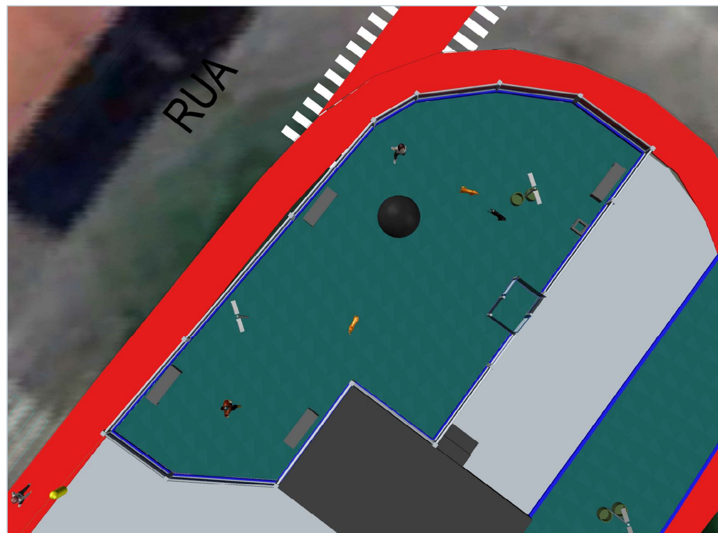
LOCAL DE IMPLANTAÇÃO DO NOVO CANTEIRO E DE 3 PILARETES DE CONCRETO NA FAIXA CENTRAL DA PRAÇA
