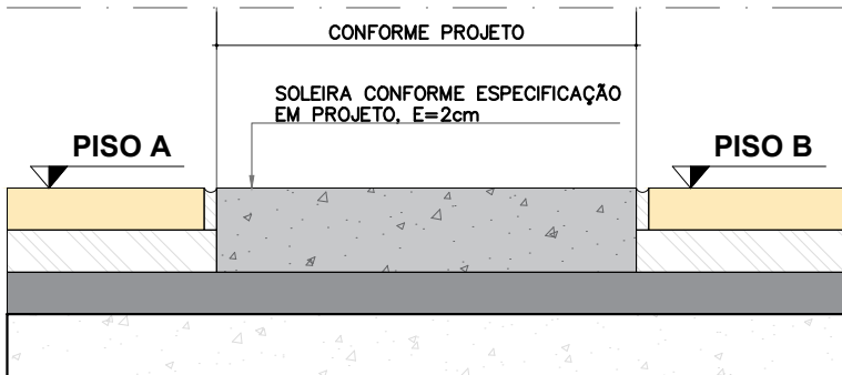
DET. SOLEIRA TRANSIÇÃO DE PISO EM NÍVEL ESC.: 1:2 INDICAÇÃO MEDIDAS EM CM
