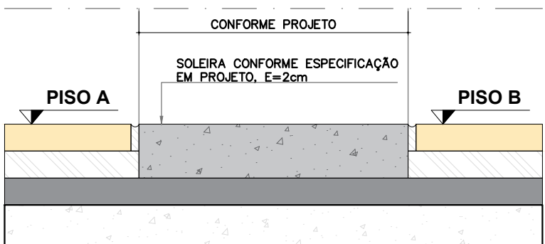
DET. SOLEIRA TRANSIÇÃO DE PISO EM NÍVEL
