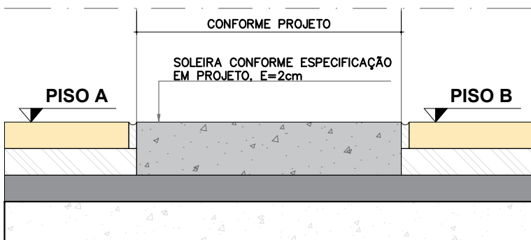
DET. SOLEIRA TRANSIÇÃO DE PISO EM NÍVEL
