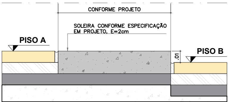
DET. SOLEIRA TRANSIÇÃO DE PISO EM DESNÍVEL
