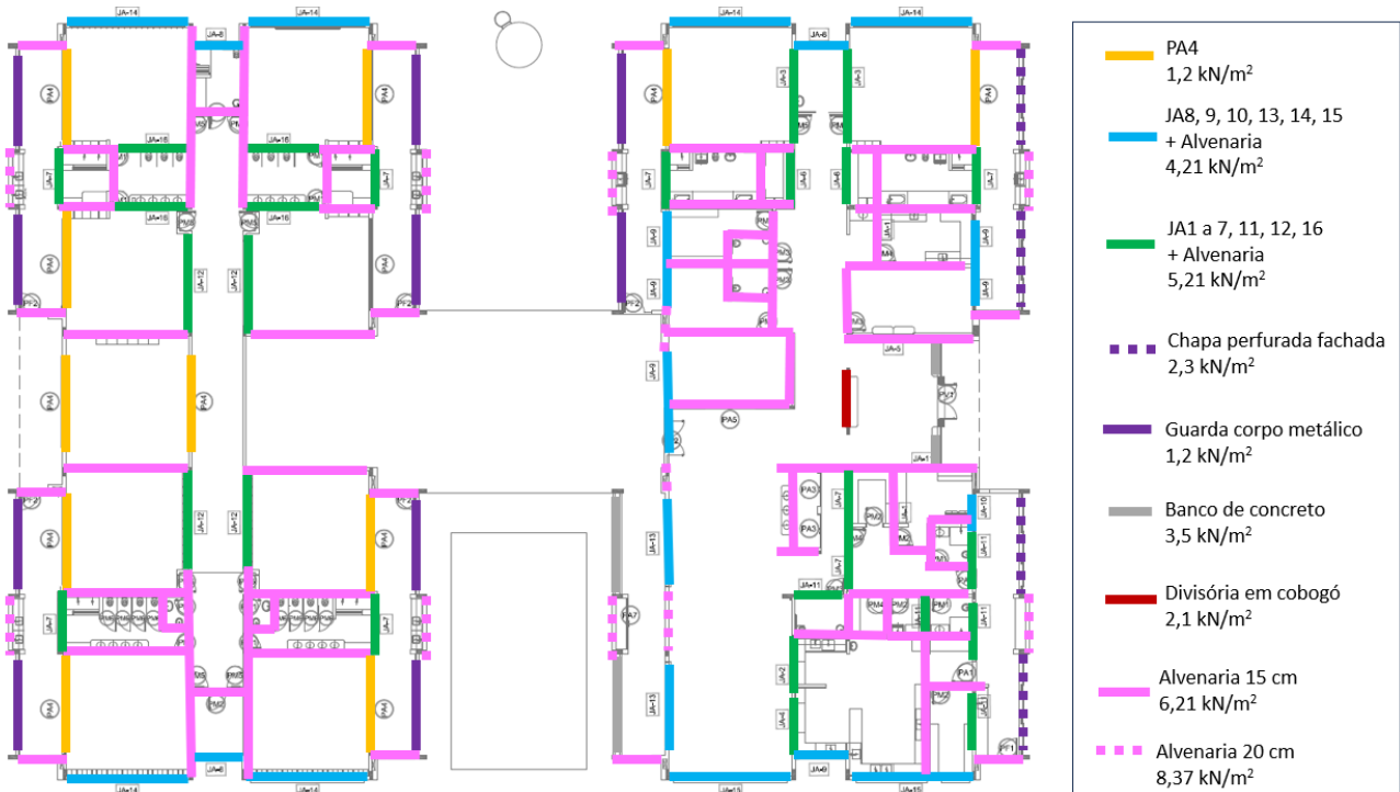
Figura 8-4 –Carga de alvenaria/ divisória (Proj Arquitetura)
